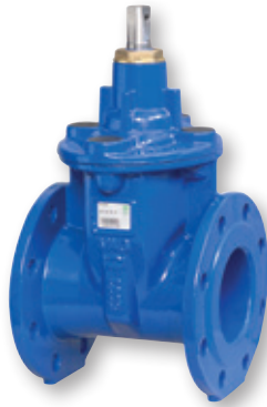
VAG EKO plus kumi-luistiventtiili laipoin Vesi ja jätevesi PN 10/16 DN 40...600 Epoksipulveripinnoite
