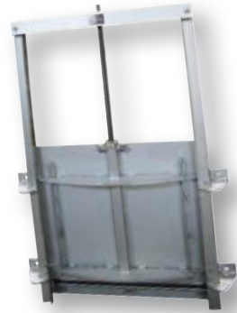
VAG patoluukut Jätevesi, vesi DN 150...4000 Tiivis 6m asti Seinämään asennettava Täyttää juomavesi standardit Ruostumatonta terästä
